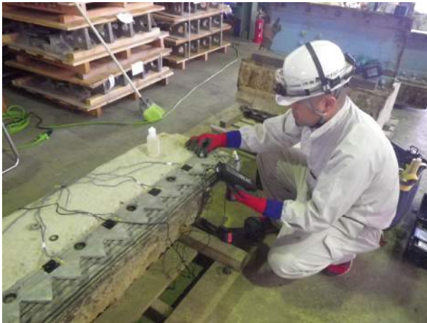
写真 3 超音波軸力計によるボルト長計測状況
