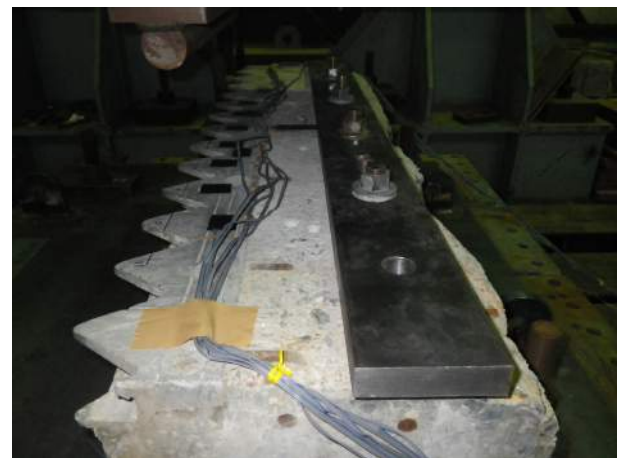
写真8 シーベックジョイント Wd-60 疲労試験供試体
