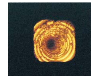
舗装後のドレイナー内部 (ファイバースコープにより撮影)
