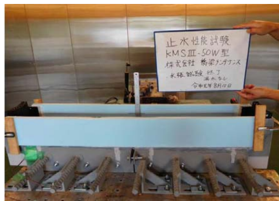
写真-4 水張り試験状況 (漏水なし)
