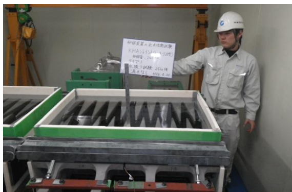
写真 19 水張り試験結果（漏水なし）
