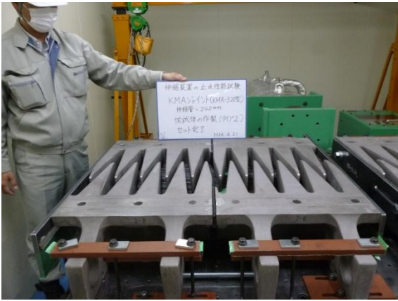
写真9 試験体接続完了（タイプ2）
