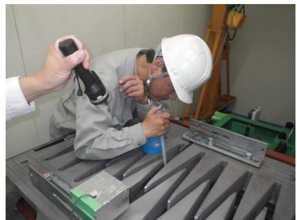
写真13 圧縮試験時の簡易水張り試験状況
