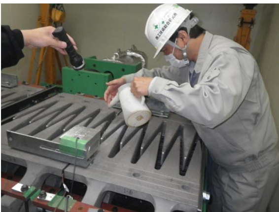
写真11 連続試験時の簡易水張り試験状況
